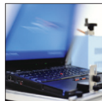
液晶ディスプレイ開閉試験
